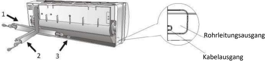
4.2 Biegen Sie die Verbindungsrohre mit dem Anschluss nach oben, wie in der Abbildung gezeigt.
