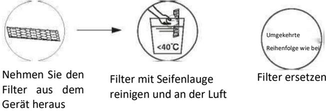
**Tipp:** Wenn sich im Filter Staub angesammelt hat, reinigen Sie den Filter bitte rechtzeitig, um einen sauberen, gesunden und effizienten Betrieb im Inneren der Klimaanlage zu gewährleisten.
